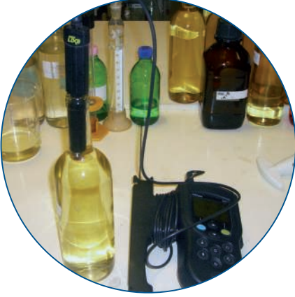
Şekiller 3 ve 4: HQD ve LDO sensörü ile bir şişede oksijen ölçümü
