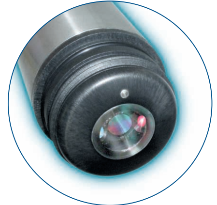
Şekil 3: Sensördeki mavi ve kırmızı LED
