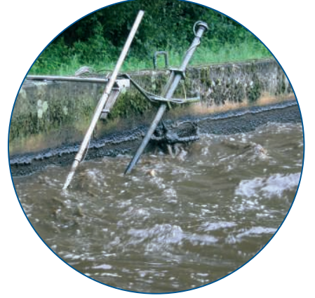
Şekil 7: Zorlu ortamlarda bile LDO sensörü normal işlev görür. Bakım miktarı minimumdur.
