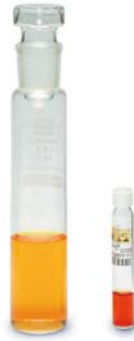
Şekil 4: Küvet testleri, geleneksel titrasyon yöntemlerinden %90 daha az kimyasal madde kullanırlar.
