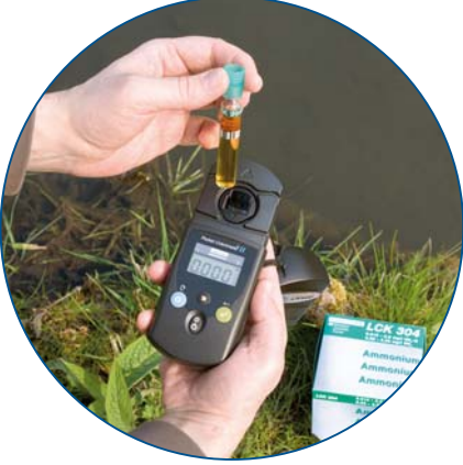
Şekil 7: Sadece bir düğmeye basarak arazide ölçüm yapılması: Yeni başlayanlar için tek-parametrelili POCKET Kolorimetre II.
