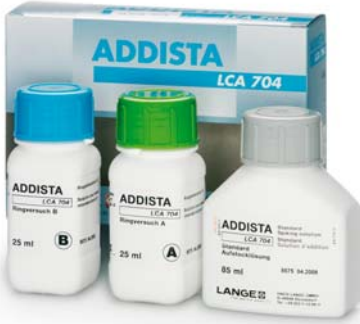
Şekil 11: Sonuçların hassasiyetini ve doğruluğunu kontrol amaçlı standart/spike solüsyonlu ve iki round robin test solüsyonlu ADDISTA.
