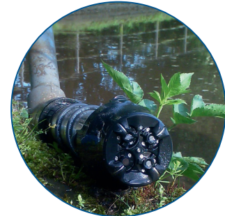
Şekil 5: Amonyum azotu içeriğinin kararlı ve sürekli izlenmesi için yenilikçi CARTRICAL teknolojisine sahip iyon seçici probu
