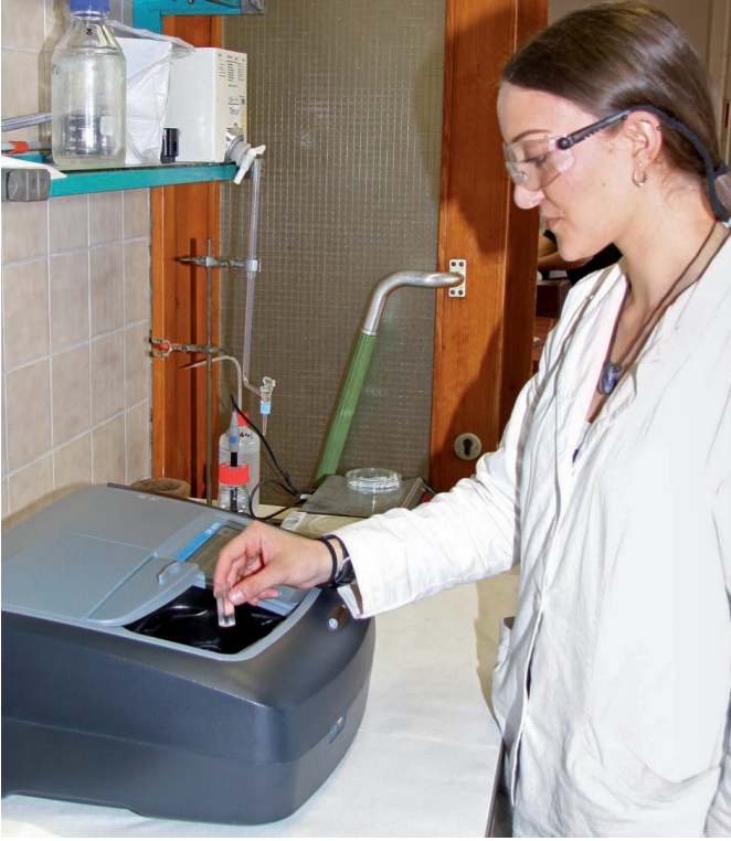
Şekil 3: Bir hücre kullanılarak numunenin yerleştirilmesi
